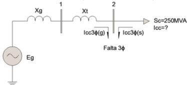
Tomando-se como valores de base a potência de 100MVA pela qual as reatâncias do gerador (Xg) e do transformador (Xt) já estão referenciadas, a parcela da corrente de falta devido ao sistema é dada por:
