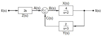
A função de transferência de qualquer sistema é dada por:  $G(s) = \frac{S(s)}{E(s)}$ .
