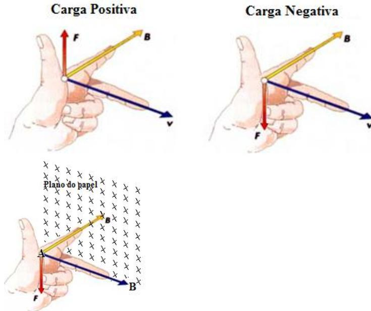
Aplicando-se esta regra na situação proposta, o vetor força que atua na carga negativa apontará para a diagonal inferior do plano, formando ângulo reto com o segmento linear  $AB$  que descreve o movimento da carga.
