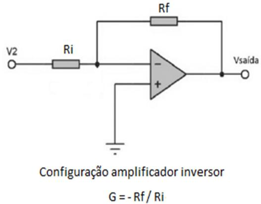
Como  $R_f = C = 10\Omega$  e  $R_i = B = 1\Omega$ , tem-se que o ganho do amplificador inversor vale:
