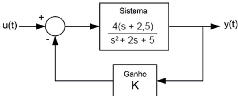
Um engenheiro deseja modificar o comportamento dinâmico de um sistema, a partir da realimentação negativa da saída com ganho  $K > 0$ , conforme apresentado na Figura acima.
