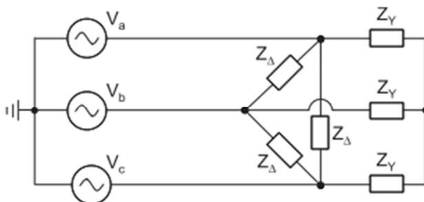
No circuito da figura acima, a fonte trifásica é ideal e balanceada. A impedância equivalente por fase desse circuito, em função de  $Z_{\Delta}$  e  $Z_Y$ , é
