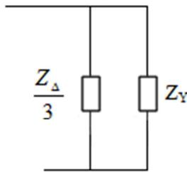
$$Z_{eq} = Z_Y \parallel \frac{Z_{\Delta}}{3} = \frac{Z_Y \cdot Z_{\Delta}}{3 \left( Z_Y + \frac{Z_{\Delta}}{3} \right)} = \frac{Z_{\Delta} \cdot Z_Y}{Z_{\Delta} + 3Z_Y}$$
